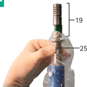
Tourner la douille 25 dans le sens des aiguilles d'une montre pour empêcher une ouverture involontaire de l'accouplement rapide UNITRAC 19
