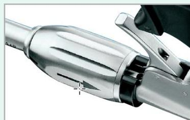
5 Faire pivoter la bague de sécurité de 180° de telle sorte que la partie « ouverte » soit sur le dessus
