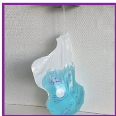
Suspension par la sonde d'un set de sondage rempli afin de vérifier la tenue des scellages.
