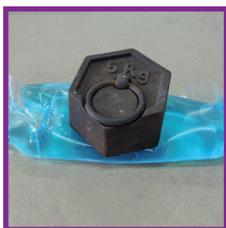
Application d'un poids sur une poche remplie pour vérifier la bonne tenue des soudures et ainsi valider la conformité de l'étanchéité du produit.
