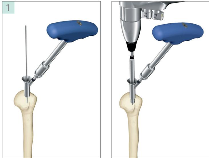
Montage du clou sur le dispositif de visée
