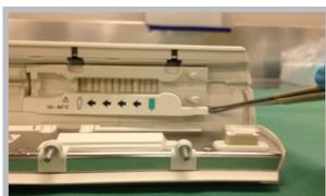
6. L'élément de guidage de ligne peut être retiré à l'aide d'un objet pointu inséré dans l'angle inférieur droit. Il est alors possible de plonger le couvercle dans un liquide pour le nettoyer et d'essuyer les "doigts" avec un chiffon doux.
